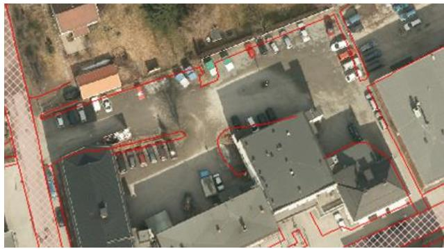
Figur 17: Eksempel på feilaktig registrert Veg i forbindelse med Annet vegareal til venstre (rød med skravur) og korrekt registrering til høyre. Veglenke fra FKB-Vegnett skal benyttes som støtte i konstruksjonsarbeidet.
