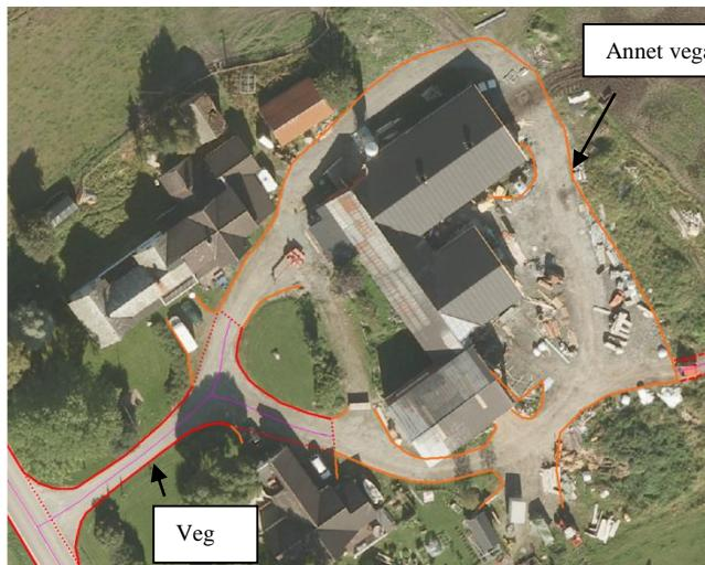
Figur 16: Eksempel på feilaktig registrert Veg i forbindelse med gårdstun til venstre (rød avgrensning) og korrekt registrering til høyre. Veglenke fra FKB-Vegnett skal benyttes som støtte i konstruksjonsarbeidet.
